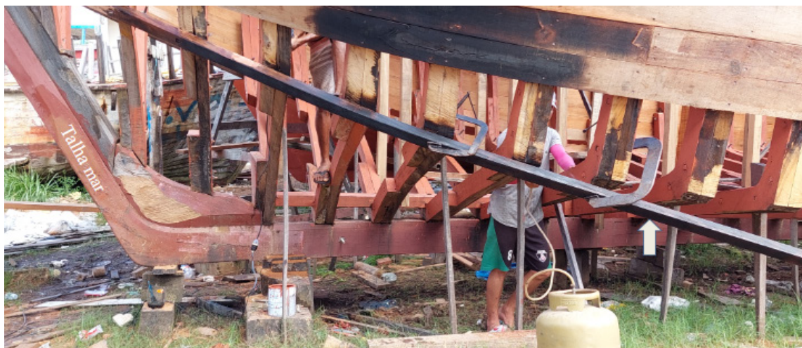
Figura 8– Processo de modelagem do canto do barco por aquecimento com maçarico. Foto: Acervo pessoal (2022).
