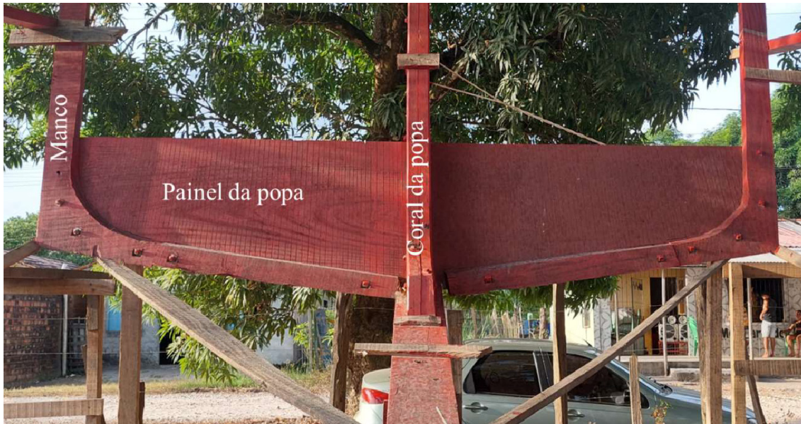
Figura 3– Visão frontal da popa da embarcação, indicando o coral da popa, o painel e o manco. Foto: Acervo pessoal (2022).
