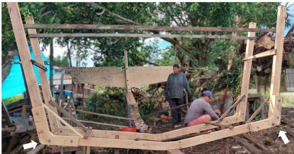
Figura 5– Cavernas de armação, com detalhe para as curvas indicadas pelas setas. Foto: Acervo pessoal (2022).
