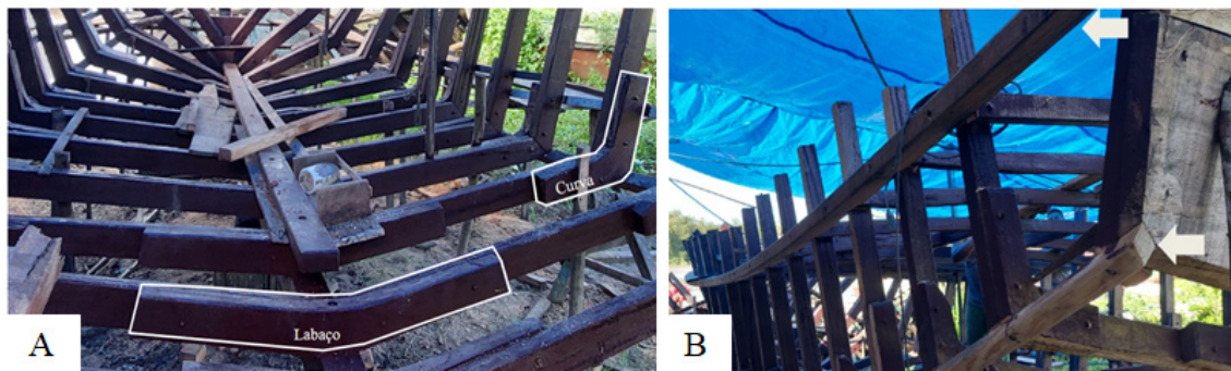
Figura 7– A. labaço e curva da embarcação; B. a seta inferior indica a peça chamada de canto e a seta superior o cintado. Foto: Acervo pessoal (2022).
