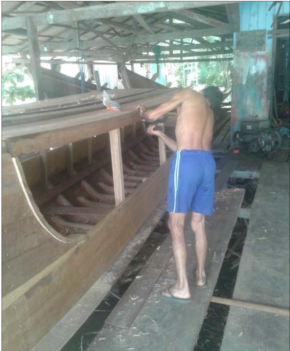
Figura 12 - Rabeta em fase de construção. Foto: Rosenildo da Costa Pereira (25 nov. 2018).
