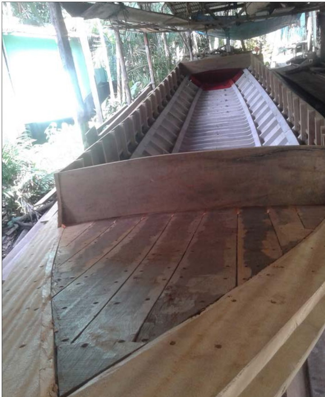
Figura 10 - Rabeta em fase de construção. Foto: Rosenildo da Costa Pereira (25 nov. 2018).
