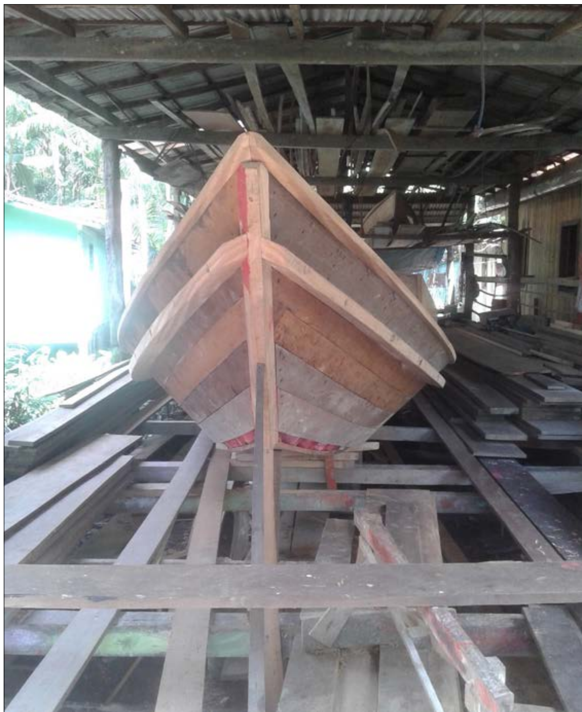
Figura 9 - Rabeta em fase construção. Foto: Rosenildo da Costa Pereira (25 nov. 2018).
