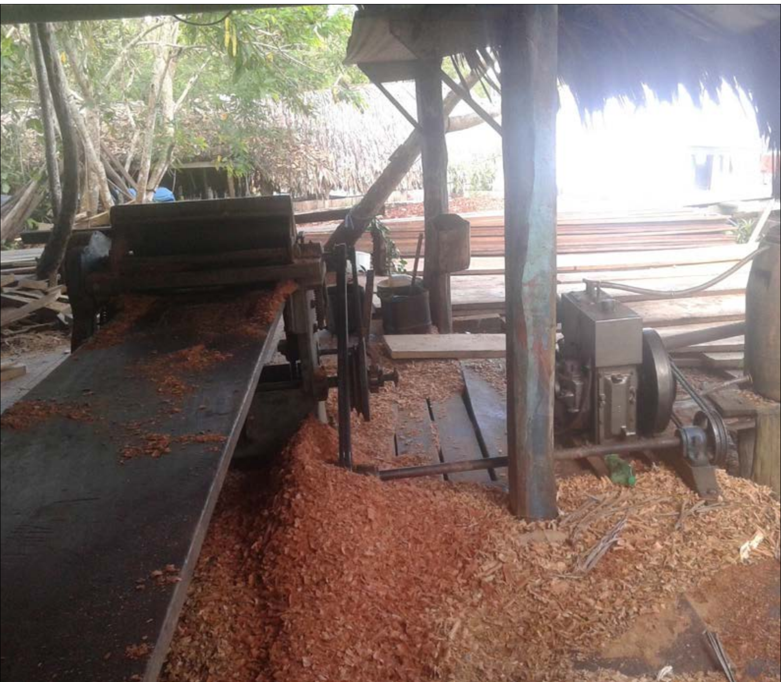
Figura 3 - Plainadora elétrica usada para fazer o polimento das madeiras empregadas na fabricação das embarcações. O equipamento funciona acoplado a um motor gerador de energia.
