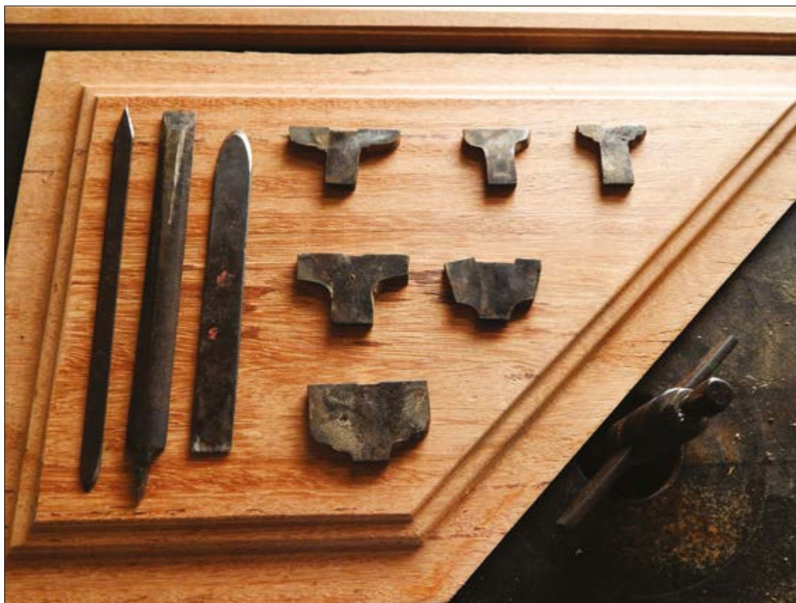
Figura 4 - Fresas feitas por Raimundo sobre peça de madeira que demonstra o resultado da fresa montada na máquina. Foto: Luiz Loureiro (2018).
