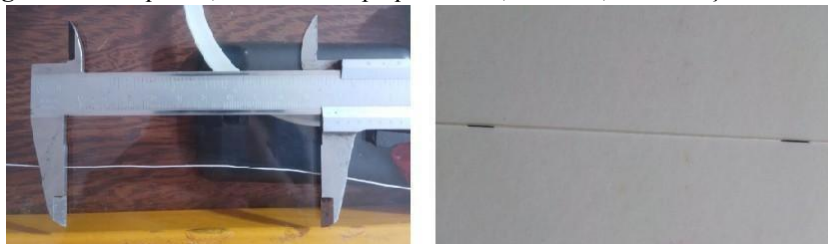
Figura 3: À esquerda, medida com paquímetro e, à direita, as marcações feitas no fio
