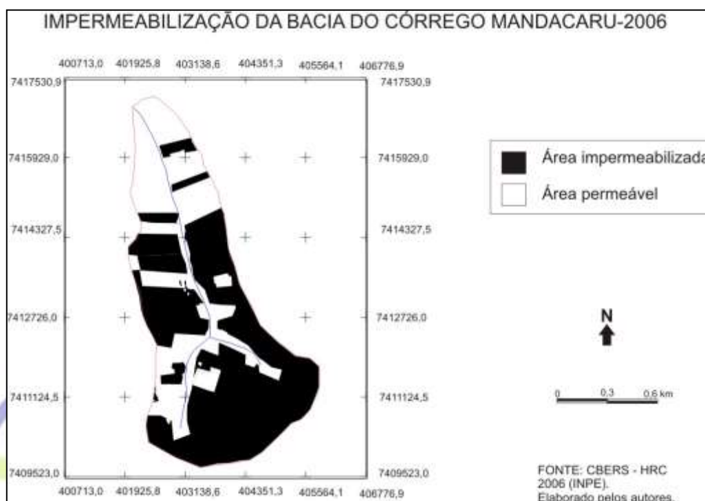
Figura 04: Impermeabilização da bacia do córrego Mandacaru em 2006.
