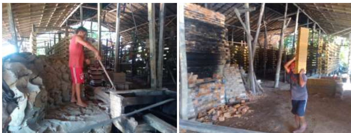
Figura 4 – Homens trabalhando na produção de tijolos, que na verdade, incia-se desde a ida à densa floresta para extração do barro. Num primeiro momento, temos o barro sendo pressionado para que possa ganhar a forma de tijolo, onde utiliza-se a força braçal. Num segundo momento, tem-se o tijolo já “seco” sendo levado para o forno. Fonte: Trabalho de campo, 2017.
