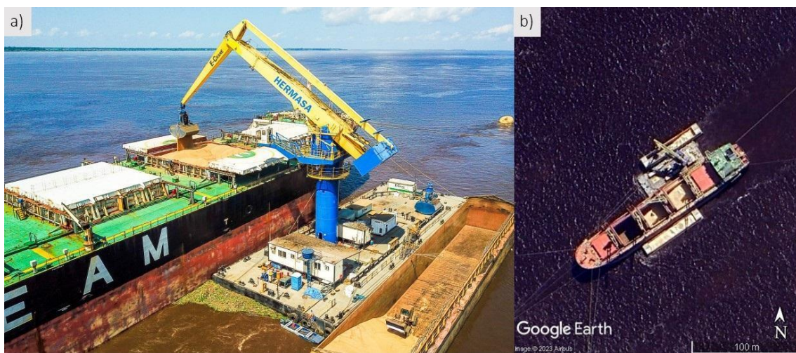
Figura 4. Balsa guindaste com estrutura de carregamento de grãos do tipo E-Crane 3000, pertencente ao grupo Amaggi. A) Ilustração do maquinário em operação de carga/descarga. B) Representação do equipamento enquanto objeto técnico móvel. Fonte: Google Earth (2023) e E-crane (2023). Org.: os autores.
