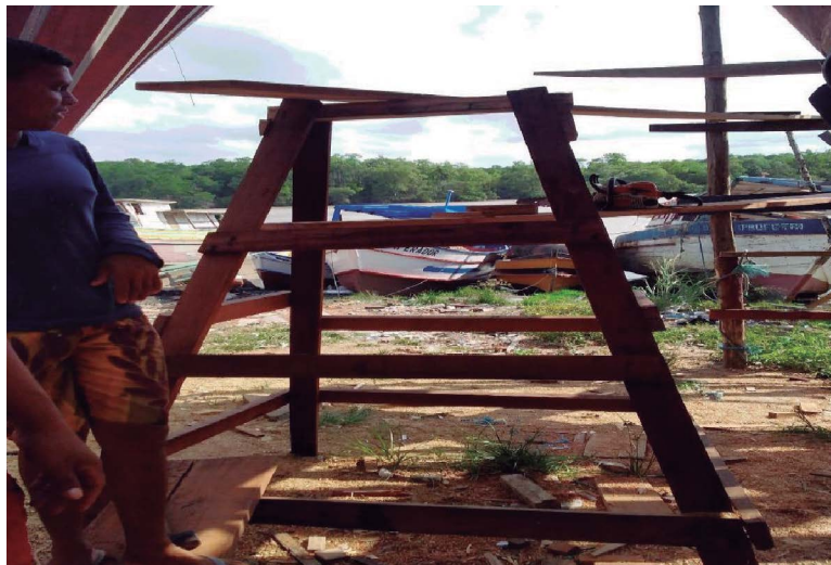
Figura 5 – Utensílio denominado cavalo usado por carpinteiros e abridores de letras navais
