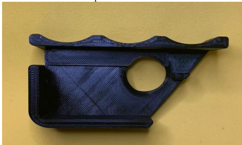
Figura 1- Acessório Facilitador para fixar os dedos do aluno no arco de violoncelo
