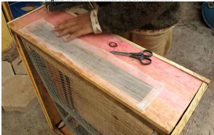
Figura 4. Entradas e saídas de ar do desidratador
