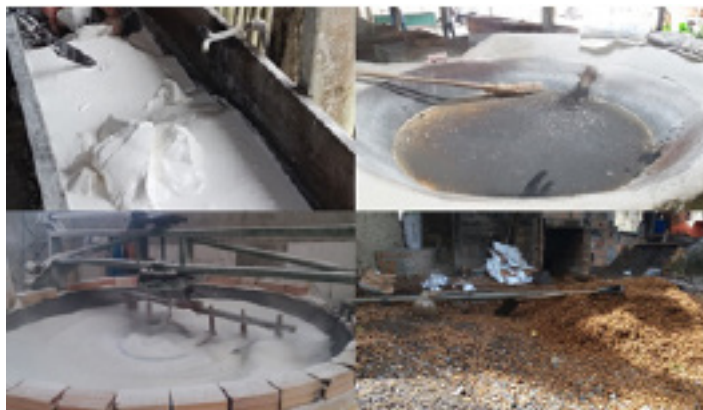
Figura 7 – Instalações e utensílios das casas de farinha da Vila de Americano: tanque de hidratação da fécula; forno artesanal; forno mecanizado e caroços de açaí para alimentação do forno
