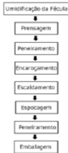
Figura 1– Fluxograma do processo produtivo da farinha de tapioca
