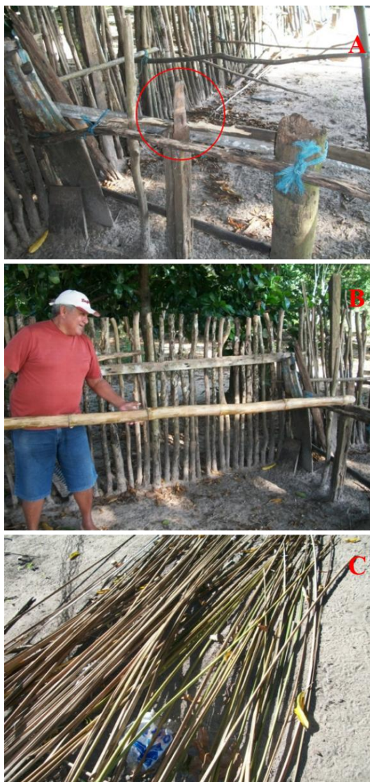
Figura 16: (A) A lâmina da serra. (B) O pescador inicia a confecção dos talos com um corte na extremidade do bambu para que possa encaixar essa abertura na lâmina. (C) Depois de partir o bambu em duas partes, o pescador usa um terçado ou facão para fabricar os talos ou varas. Fonte: Pesquisa de campo, 2012.
