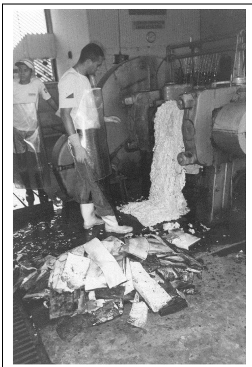
Foto 05 - Processo de industrialização da borracha. (Foto Assunção Amaral, 2004)
