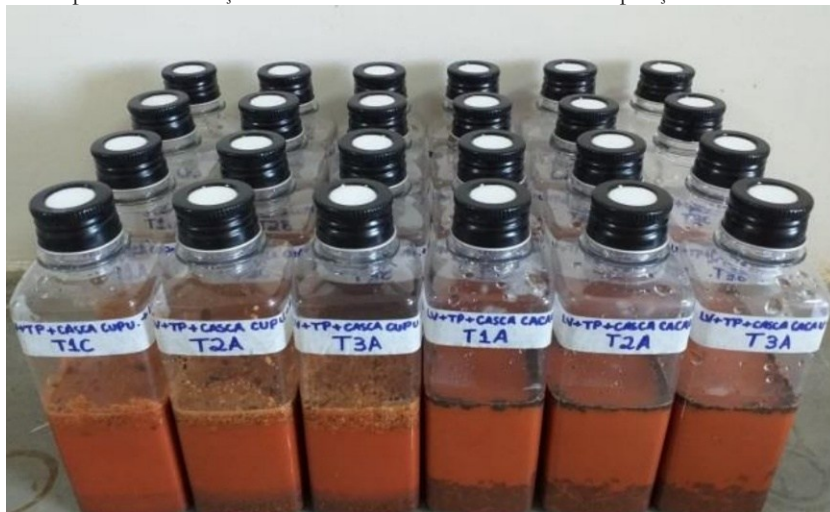
Figura 2 – Sistemas para neutralização da lama vermelha com casca de cupuaçu e cacau nos recipientes.
