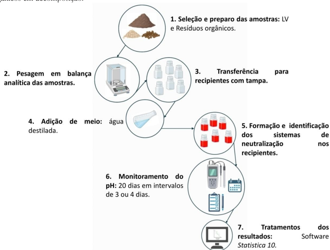
Figura 3 – Fluxograma ilustrado das etapas desenvolvidas na fase de neutralização da LV com os resíduos orgânicos em decomposição.
